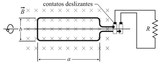
A figura acima mostra o esquema básico de um gerador comercial de corrente alternada de 60 Hz e voltagem de 220 V. Esse gerador é constituído de uma bobina retangular de comprimento  $a$  e largura  $b$ , com  $N$  espiras, que gira com a frequência  $\omega$  na presença de um campo magnético uniforme  $B$ . A bobina está ligada a um cilindro que gira junto com ela.
