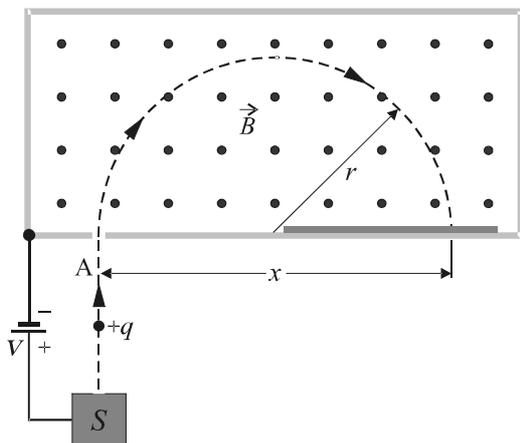
A figura acima ilustra esquematicamente um espectrômetro de massa. Um íon produzido na fonte  $S$  é acelerado por um campo elétrico constante devido à diferença de potencial  $V$ . O íon entra, por uma abertura  $A$ , em uma câmara onde há um campo magnético uniforme  $B$ , perpendicular à trajetória do íon. Após algum tempo, o íon choca-se com uma placa fotográfica à distância  $x$  da abertura.
